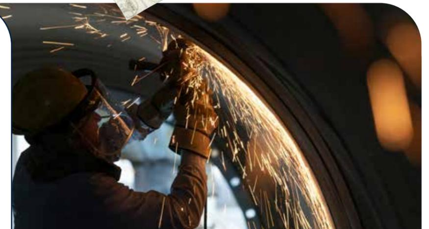
Wir verarbeiten Schleifkorn aus Siliziumcarbid zur Anwendung bei festen Werkstoffen, Aluminiumoxid zur Bearbeitung von langspanenden Werkstoffen wie Holz und Metall und Zirkonkorund für das Schleifen von zähen Werkstoffen wie Edelstahl.
